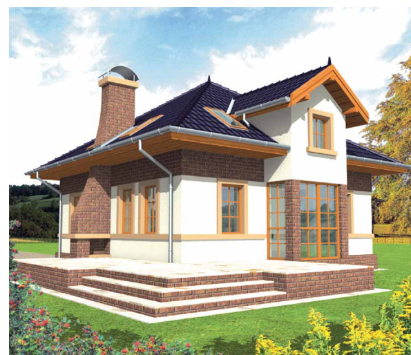
Komin może być usytuowany na zewnątrz budynku. W projekcie „Niobe” jest on połączony z kominkiem tarasowym. [Proj. Archipeląg]
